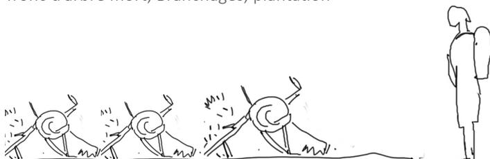
**Situation particulière** En cas de nécessité, un système de fascines pourra être mise en œuvre, seul ou à l'arrière de branchage pour renforcer le principe général.
