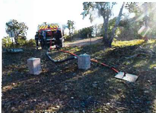
Test d'aspiration de la citerne DFCI FRJ17 de 120 m 3 au Malpey le 14 janvier 2022
