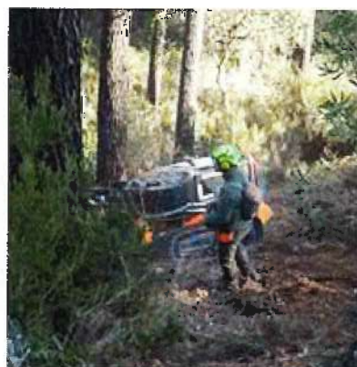
Utilisation d'un gyro broyeur robot
